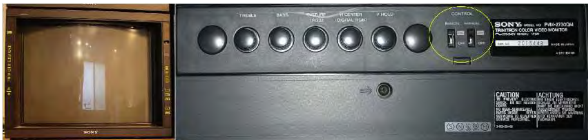
Afbeelding 18. L: Sony PVM-2730 QM monitor met manuele bediening ingeschakeld (verlicht aan de randen), R: schakelaar voor manuele bediening monitor (gele cirkel)
