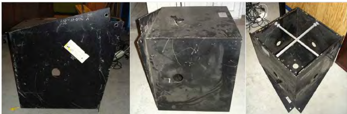
Afbeelding 21. L: achteraanzicht centrale kubus, M: zijaanzicht centrale kubus, R: vooraanzicht centrale kubus (interne versteviging)
