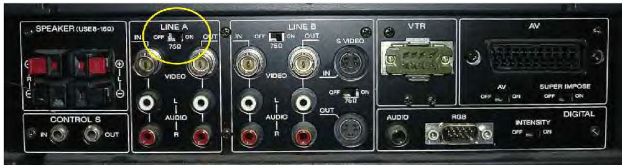
Afbeelding 19. schakelaar '75 Ohm ( \Omega )' achterkant monitor (gele cirkel)
