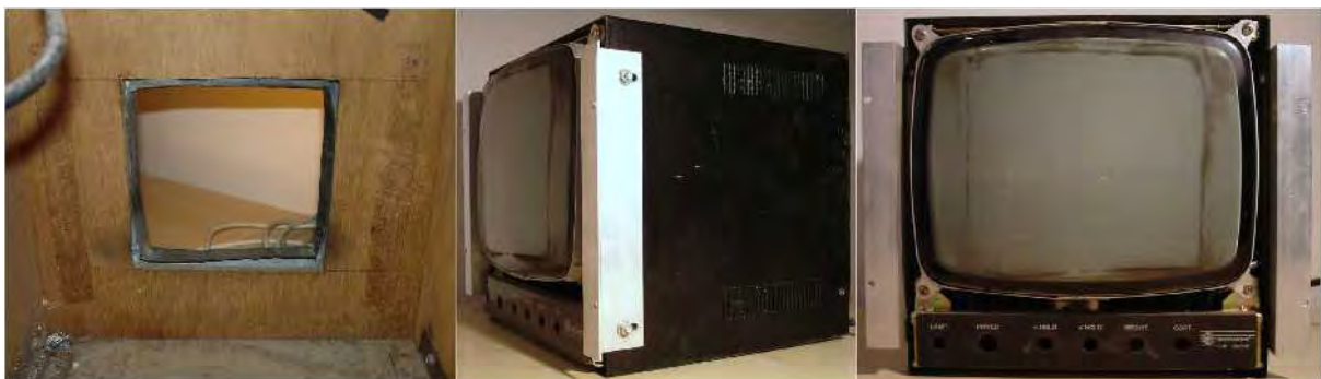
Afbeelding 5. L: uitsparing monitor achteraan, M: monitor met hoekprofielen driekwartaanzicht, R: monitor met hoekprofielen vooraanzicht
