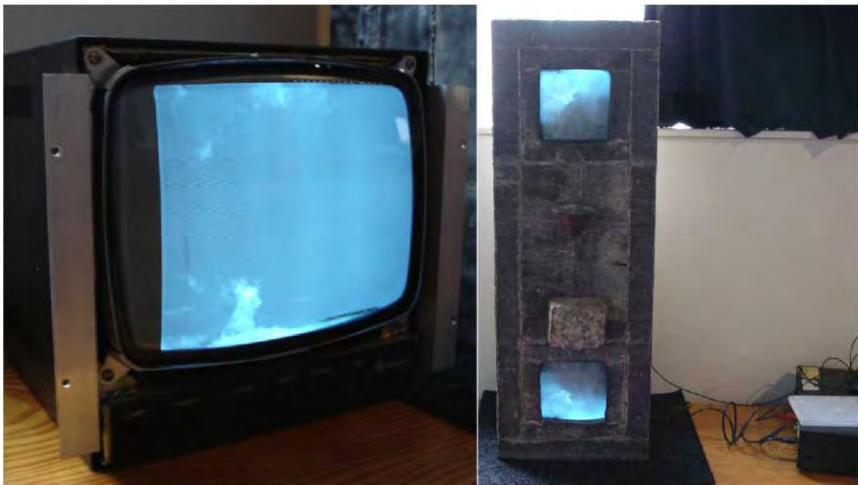
Afbeelding 9. L: verschuiving van beeld van gerepareerde monitor, R: testopstelling Panta
